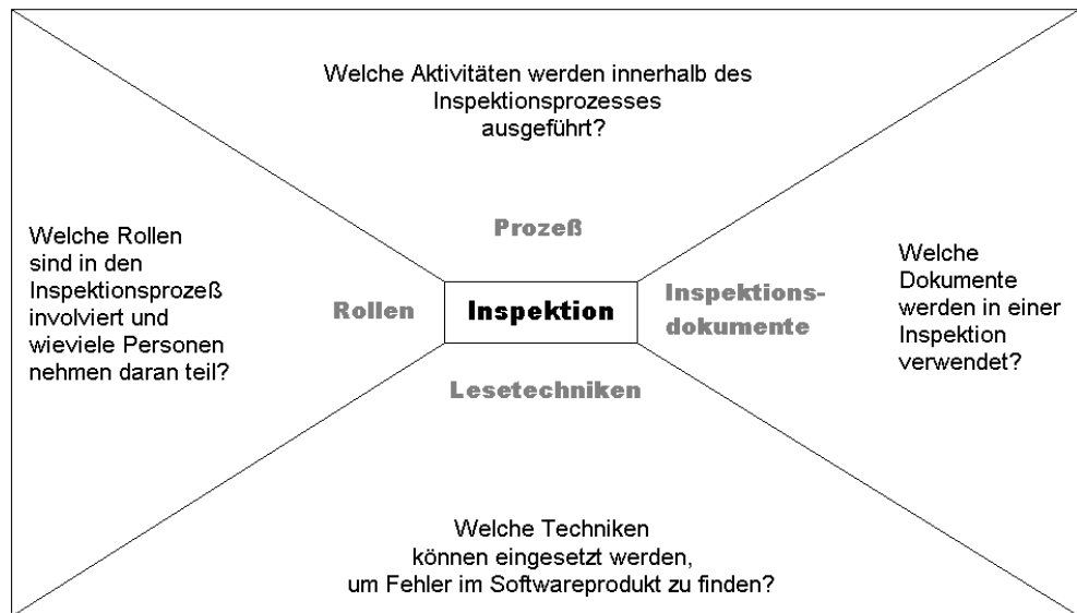
Abbildung 3-2: Die vier Dimensionen des Inspektionsprozesses
